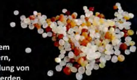
Nurdles sind Plastikpellets mit einem Durchmesser von 2 bis 5 Millimetern, die als Rohmaterial für die Herstellung von Kunststoffprodukten verwendet werden.
